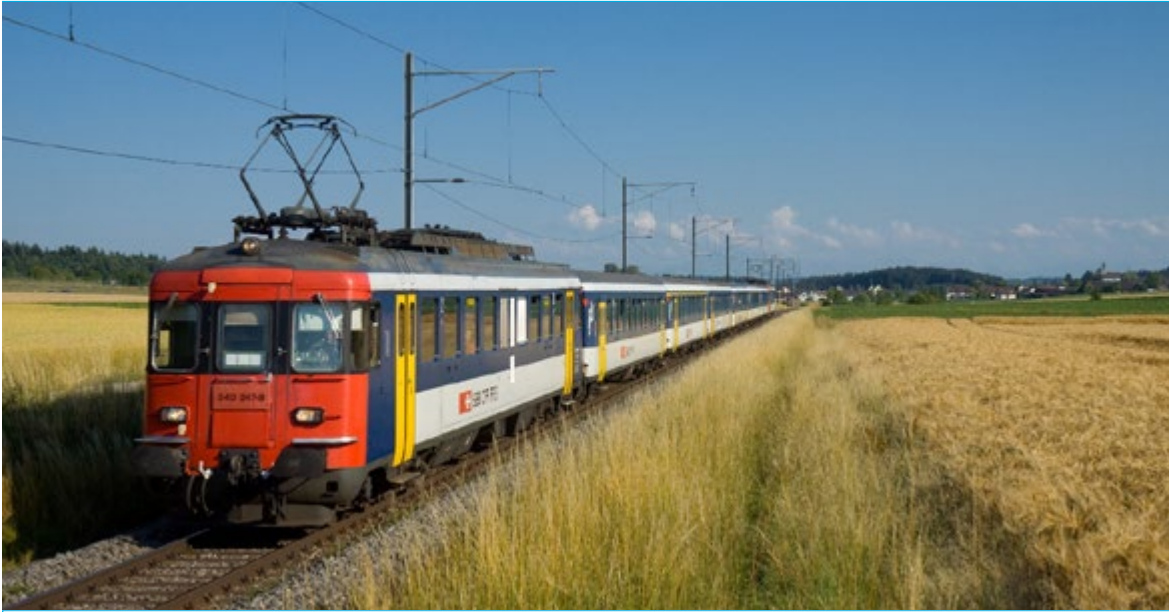
Automotor sèrie 540 dels ferrocarrils suïssos remolcant cotxes de viatgers.
